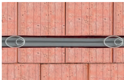
Крепление кабелей в штробах стен шириной > 30 мм
