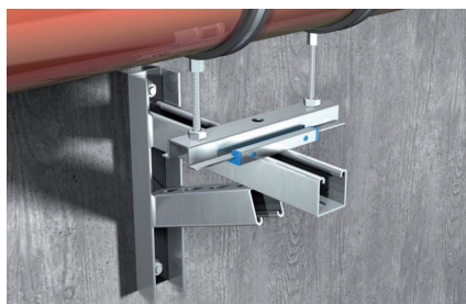
Подвижная опора, закрепленная на консоли
