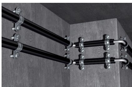
Крепление стальных трубопроводов в защитной оболочке
